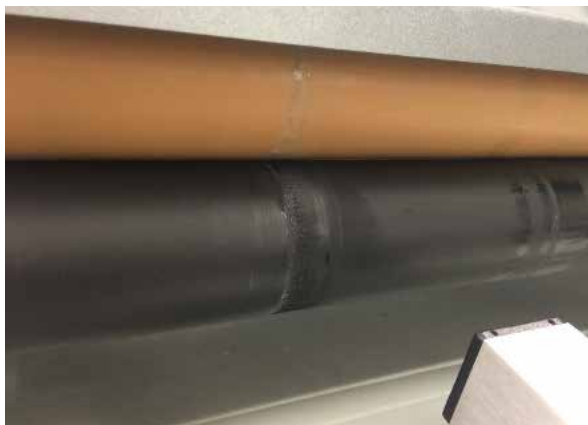
Abbildung 7: Eintrocknete Rückstände auf der Walzenoberfläche
