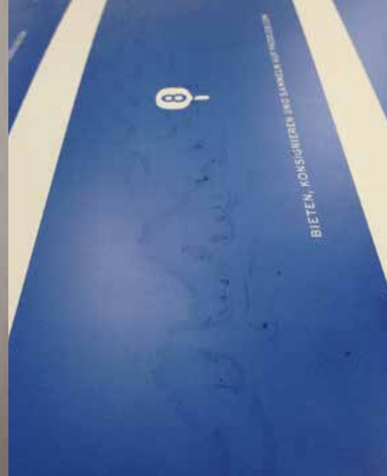
Abbildung 4: Schichtablagerungen aus dem Entwickler
