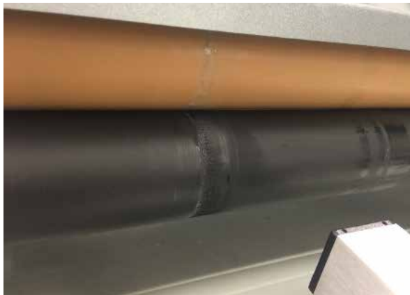
Figura 7: Residuos secos en la superficie del rodillo
