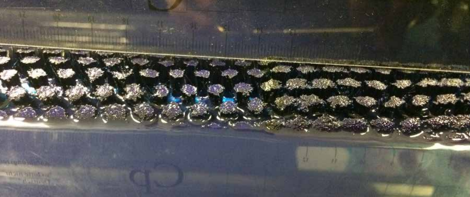
Figura 5: Cepillo de revelador desgastado
