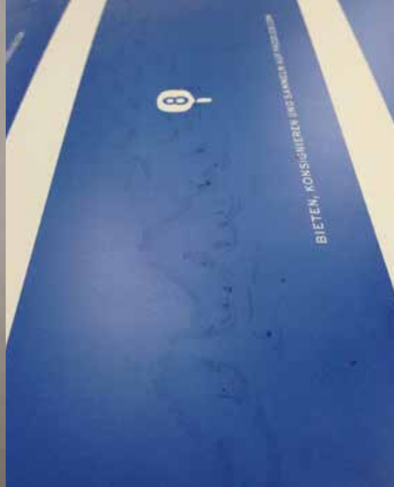
Figura 4: Redepósitos del revelador
