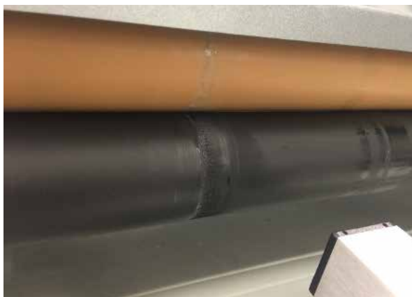
Figure 7 : Résidus secs à la surface du rouleau
