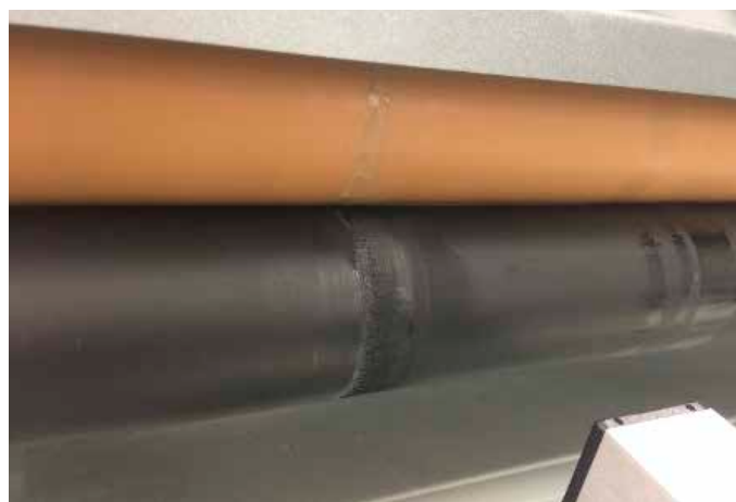
写真7：ローラー表面に残った乾燥した残存物
