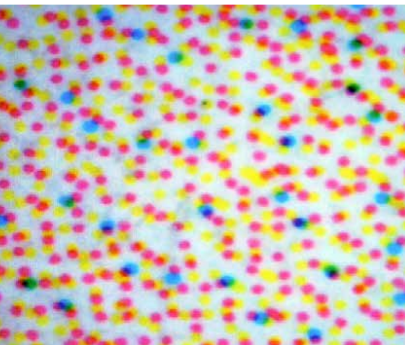
Figure 3 - Placement des gouttelettes : comparaison entre des gouttelettes KODAK STREAM (à gauche) et des gouttelettes générées par un système DOD (à droite)
